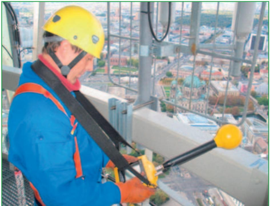
Festlegung von Sicherheitsbereichen. Sind es wirklich die Antennen für den digitalen Rundfunk (DAB), die den Hauptbeitrag zur Feldexposition leisten, oder sind es die UKW-Antennen mehrere Etagen höher? Auskunft gibt eine selektive Messung mit SRM-3000, dem Selective Radiation Meter von Narda Safety Test Solutions.
