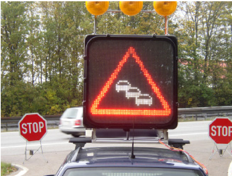
Von Firma Nissen entwickeltes LED-Display mit frei programmierbaren Texten und hinterlegten Verkehrszeichen zur besseren Absicherung von Einsatzstellen
