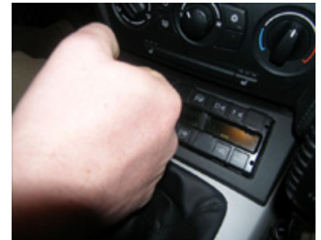
Steuereinheit für Blaulicht und Anhaltesignalgeber. Betätigung des Blaulichts und Sondersignal für Beifahrer bei Einsatzfahrten nicht möglich.
