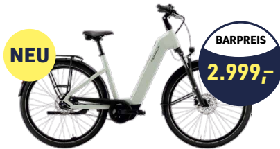
PEGASUS SOLERO EVO 7F BELT MOTOR Bosch Performance Line (75 Nm) AKKU 600 Wh DISPLAY Bosch Purion 200 ZULÄSSIGES GESAMTGEWICHT 150 kg
