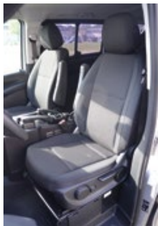
Multifunktionaler Polizeisitz im Mercedes Benz „Vito“, eine Neuentwicklung der Daimler-Benz AG nach Vorgaben aus dem Gutachten des Fraunhofer Instituts und der Universität Stuttgart.
