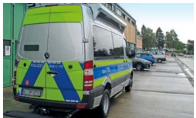
Signalbeklebung mit den gelb fluoreszierenden Folien im „Chevron-Muster“ – Grundfigur ist das „warnende Dreieck“.
