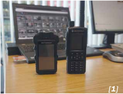
[1] Der Bodycam-Satz bestehend aus Funkgerät, Display und Kamera (im Vordergrund), SINA-Workstation und DVD-Brenner (im Hintergrund). [2] Ladestation des Funkgerätes und des Bedienteils mit Kamera. [3] Kennzeichnung der Videoaufzeichnung, in diesem Fall auf dem Rücken (anstelle von „Polizei“). Fotos: GdP
