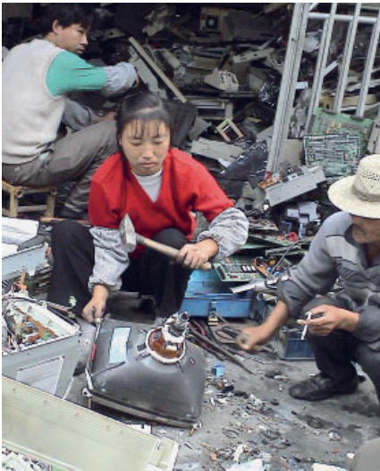
Chinesische Arbeiterin, die einen Monitor zertrümmert, um an die Kupferspulen zu gelangen. Das Monitorglas ist schwermetallhaltig und die Innenbeschichtung des Monitors enthält Verbindungen, die beim Einatmen gesundheitsschädlich sind. Das Monitorglas gelangt als wertlos auf wilde Deponien mitten in Wohngebieten und belastet Boden und Grundwasser. Foto: Basel Action Network 2006
