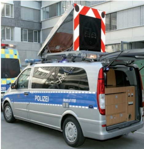
Modell "Autobahn" mit POLFIS-Anlage und Schrankausbau im Heck des Fahrzeugs
