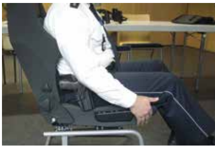
Seitlicher Halt im Bereich der Rückenlehne ist vorhanden - viel Platz für die Dienstwaffe. Im Sitzbereich sind asymmetrische, seitliche Stützen möglich.
