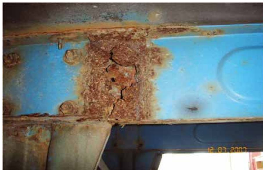
Bei Verkehrsüberwachung festgestellt: Durchgerosteter LKW Rahmen
