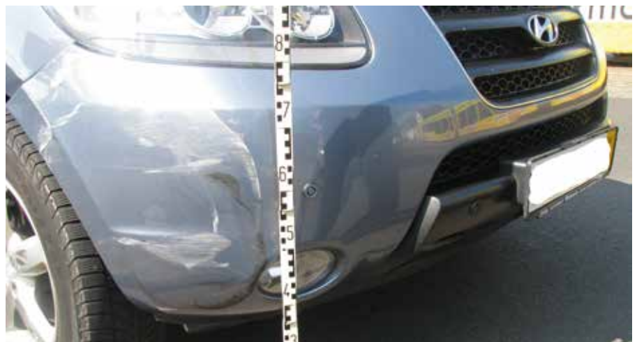
Täterfahrzeug, das bei einem vom Täter behaupteten Vorfahrtsfall dem Opferfahrzeug in die linke Fahrzeugseite fuhr. Anhand der dargestellten Spuren und Schäden an beiden Fahrzeugen hat sich der Schadensfall tatsächlich bei einem Fahrstreifenwechsel ereignet.
