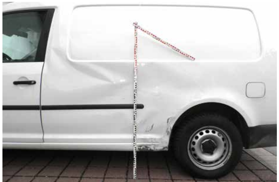
Opferfahrzeug mit dem typischen Spurenbild (Reifenantragsspuren) vom Täterfahrzeug, das nach rechts in das Opferfahrzeug hineingelenkt wurde.
