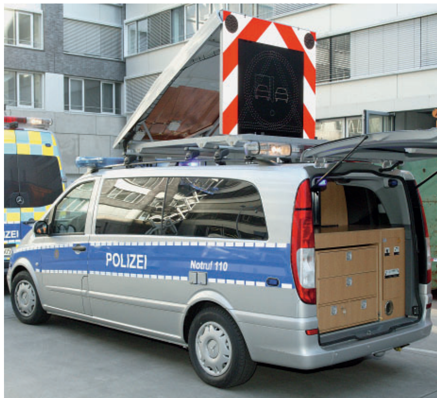
Modell „Autobahn“ mit POLFIS-Anlage und Schrankausbau im Heck.
