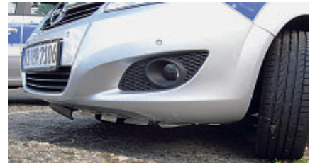
Der Frontspoiler sitzt zu tief – er ist bei fast allen Einsatzfahrzeugen bereits beschädigt.
