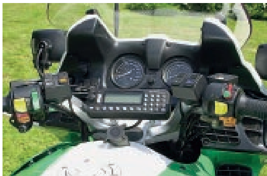
Prototyp einer digitalen Funkausstattung für ein Krad – getestet wird es z. Zt. im Projekt „Digitalfunk Aachen“.
