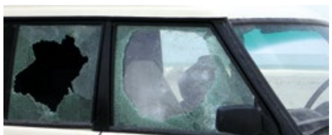
Unten: Hinteres Fenster ohne Schutzfolie. Beifahrerfenster mit Schutzfolie PROFILON® AM A1.
