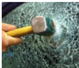
Links: Praxistest an einer mit Schutzfolie gesicherten Scheibe.
