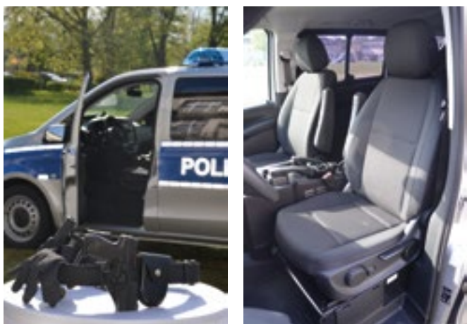
Multifunktionaler Polizeisitz im Mercedes Benz „Vito“, eine Neuentwicklung der Daimler-Benz AG nach Vorgaben aus dem Gutachten des Fraunhofer Instituts und der Universität Stuttgart.
