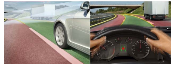
LDW warnt den Fahrer z.B. über ein vibrierendes Lenkrad.
