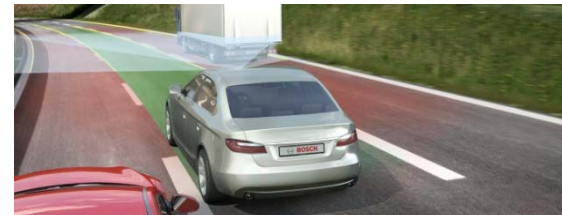
Eine Kamera erkennt die Fahrspur und die Position des Fahrzeugs
