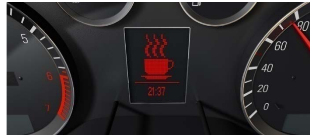
Fahrerinformation durch z.B. durch Einblendung Kaffeetassensymbol
