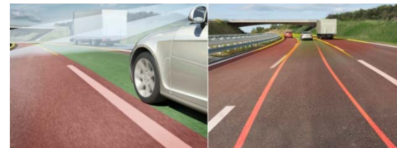
LKS hält durch Lenkimpulse das Fahrzeug aktiv in der Fahrspur.
