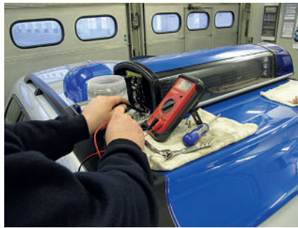
Reparatur der Sondersignalanlage.
