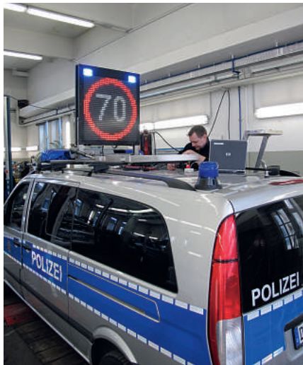
Aufbau und Reparatur der WeniPol-Anlagen.
