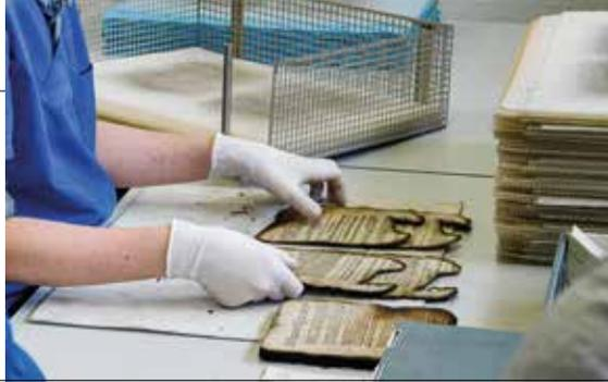
Die beschädigten Seiten werden vereinzelt und in Kompressionskassetten eingelegt.
